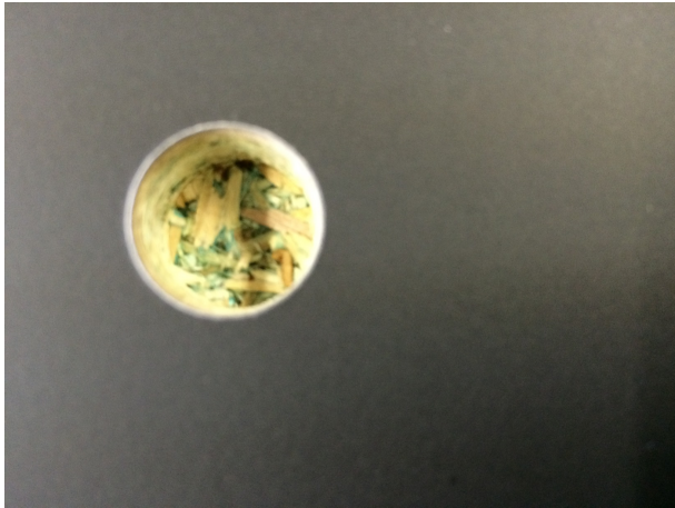
Otwór nieprzelotowy, średnica 16 mm
